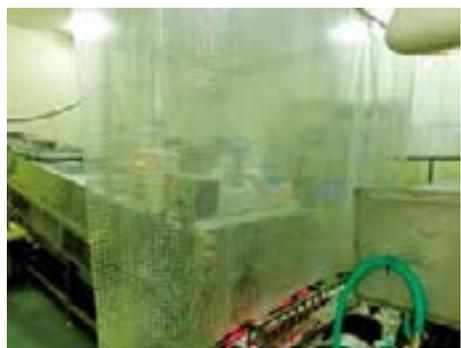
ナルト蒸機への断熱強化ビニールの仕切り
