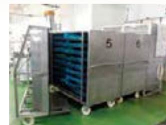
蒸気式原料肉解凍機
